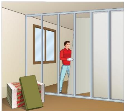
Posa in opera sistema a secco
